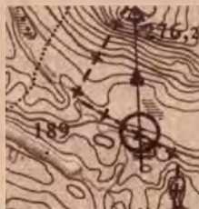
Alláspontmeghatározás oldalmetszéssel. A határon állva álláspontunkat a háromszögeles pontot beírva meghatároztuk meg. A kapott metsződések jó, kb. 50 fokos
