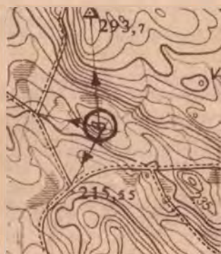
Alláspontmeghatározás hátramszéllel. Az ellenőrző harmadik irány hibaháromszöget eredményezett, de az elfogadható kicsi
