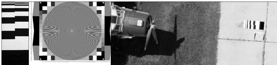
2. ábra A közepes magasságból is alkalmazható vonalas felbontási teszt és az alacsony relatív repülési magasságnál bevált Siemens-csillag állványról és levegőből
