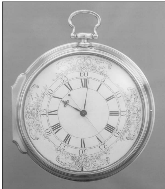
Harrison timekeepers H4 (súly: 1.45 kg, átmérő: 12 cm)
