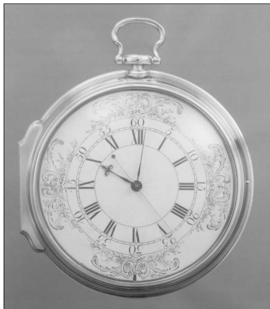
Harrison timekeepers H4 (súly: 1.45 kg, átmérő: 12 cm)
