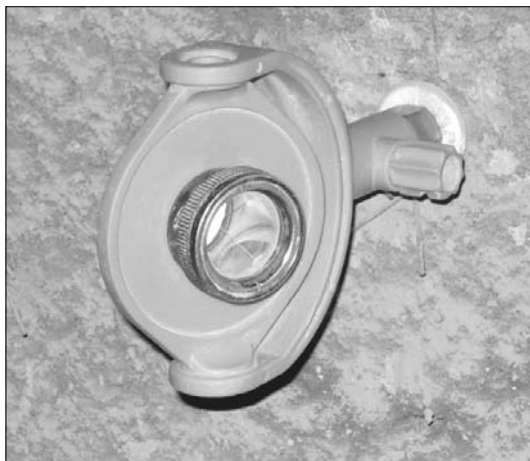
5. kép A vágat oldalfalában prizmával mérésre várakozó alappont
