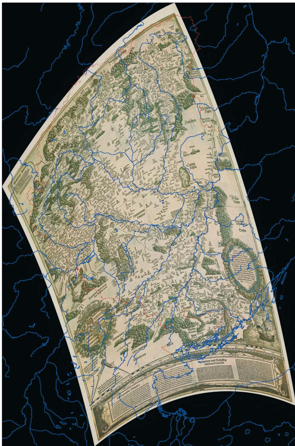
Lázár deák térképének másodrendű polinomiális illesztése UTM vetülethez illesztőpontok alapján, a mai folyóhálózat feltüntetésével (cikk a 26–30. oldalon).
