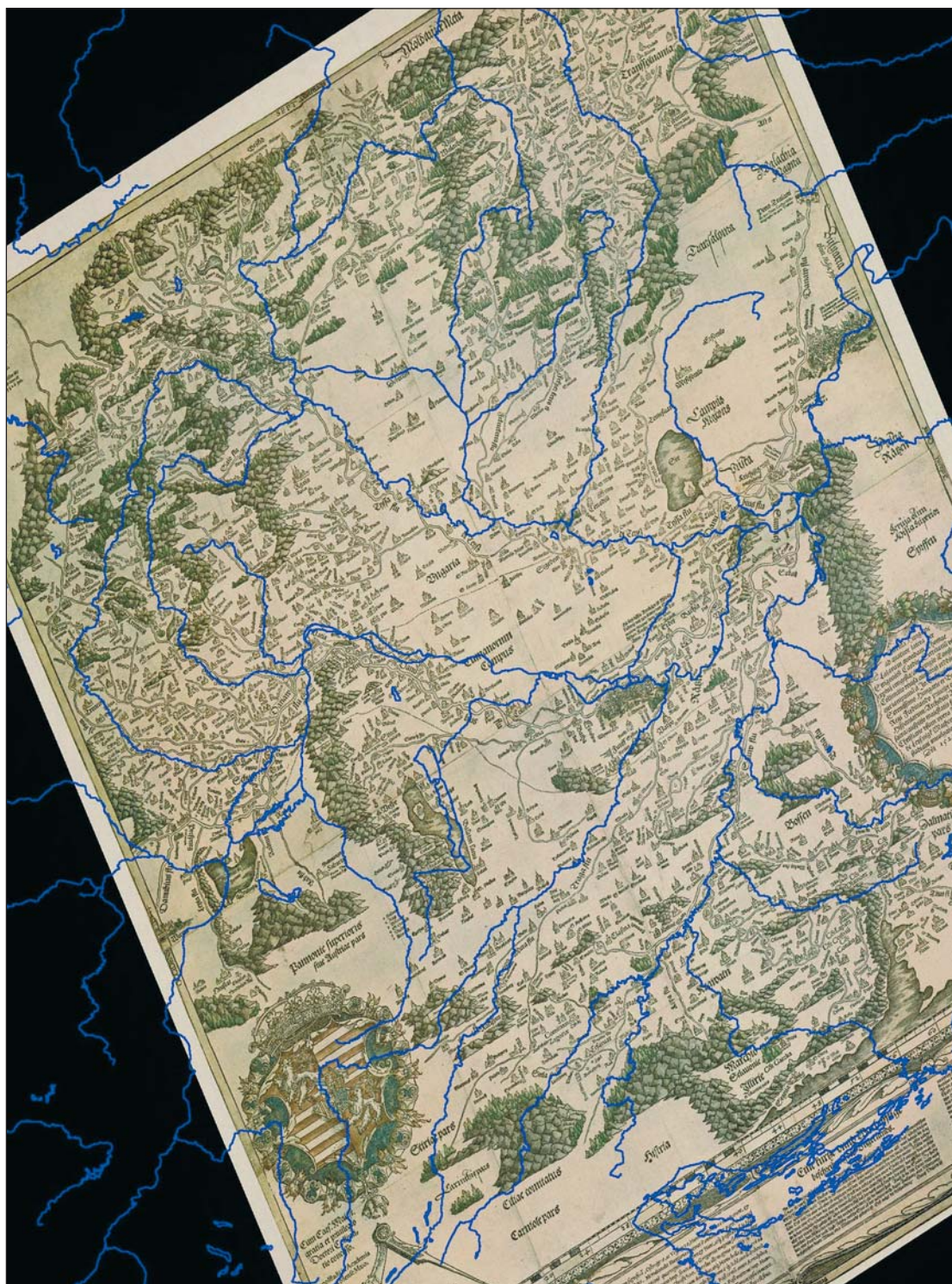
Lázár deák térképének lineáris illesztése az UTM vetülethez illesztőpontok alapján. A térképi terület téglalap helyett általános paralelogramma, jelezve, hogy a mű nem ebben a vetületben készült. A mai folyóhálózatot az illeszkedés pontosságának érzékeltetésére szerepeltetjük (cikk a 26–30. oldalon).
