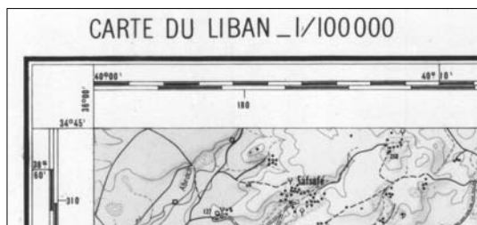
5. ábra Libanon 1:100 000 méretarányú topográfiai térképszelvényének sarka. A hosszúságok párizstól adottak, a földrajzi koordináták megírásánál a „G” a gon (újfok) szögmértéket jelenti.
