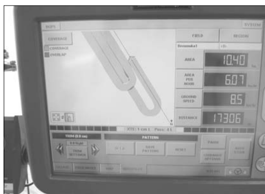
A robotpilóta-vezérlő kezelőfelülete sorcsatlakozás művelete közben
