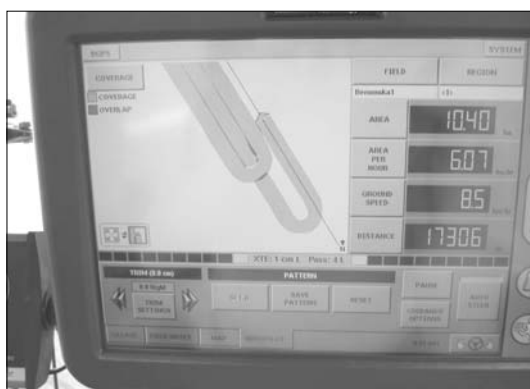
A robotpilóta-vezérlő kezelőfelülete sorcsatlakozás művelete közben
