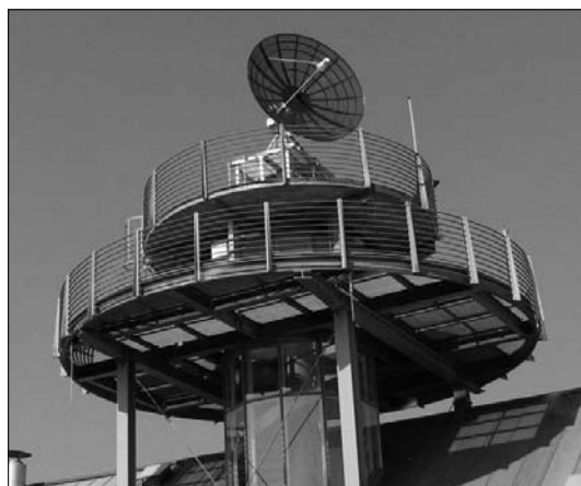
1. ábra A műholdvevő állomás az ELTE északi tömbjének tetején. A kép készítésekor a vevő aktív állapotban volt, a készenléti állapotban a parabolatányér a zenit irányába néz.
