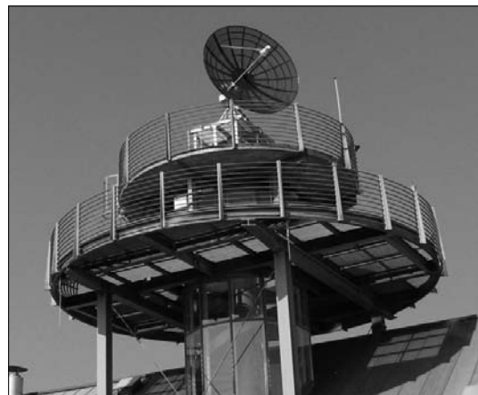
1. ábra A műholdvevő állomás az ELTE északi tömbjének tetején. A kép készítésekor a vevő aktív állapotban volt, a készületi állapotban a parabolatányér a zenit irányába néz.
