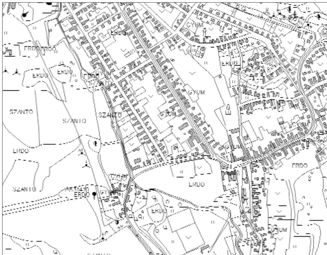
2. ábra A sztereofotogrammetriai kiértékelés eredménye
