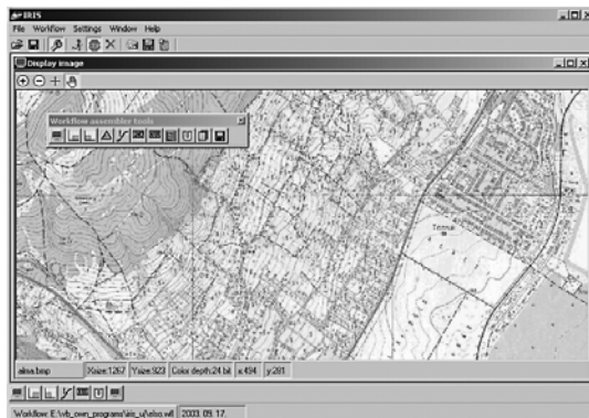
9. ábra Az ábra közepétől balra láthatjuk az elemi processzek kollekcióját, amelyből összeállíthatjuk a workflowkat. Az ábra bal alsó sarkában egy már létező workflow elemi processzeinek grafikus szimbólumait láthatjuk. Ebből láthatjuk, hogy mit fog csinálni a workflow (megjeleníti az eredeti képet, alulvág, felülvág, medián szűr, szegmentál, megjeleníti az eredményt).
