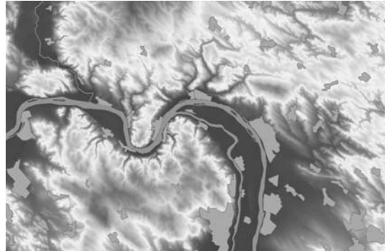
3. ábra Az eredeti adatrendszer rétegszínezéses megjelenítéssel. A mintavételi távolság 50 m.
