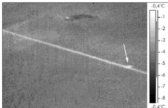
1. ábra Termálvíz-vezeték lyukadása hőfelvételen (2000. 02. 18.)
