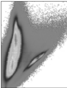
6. kép A vörös és a közeli infravörös sáv kétdimenziós histogramja (vízszintes tengely: vörös, függőleges: közeli infravörös sáv)
