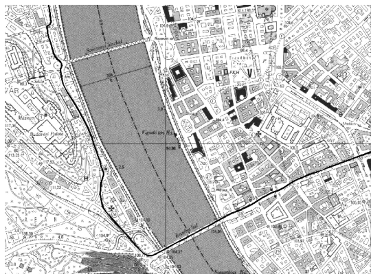
7. ábra Az abszolút pozíciók illeszkedése a digitális várostérképre a WGS-84 \rightarrow EOVSz transzformáció után (mérés navigációs vevővel Budapesten, 2002. március 27-én)
