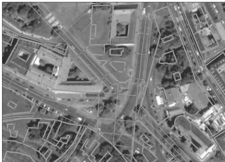
4. ábra A Szarvas tér műholdfelvételen és fölülte a georeferált Marek-térkép vektorizált változata. Kék színnel láthatók az 1875-ös épületek, pirossal a szintezési pontok és egyes mérési vonalak.
