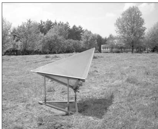
7. ábra A mesterséges műholdradar-reflektor prototípusa az obszervatórium kertjében, az ESA ENVISAT műholdjának ASAR szenzorához beállítva
