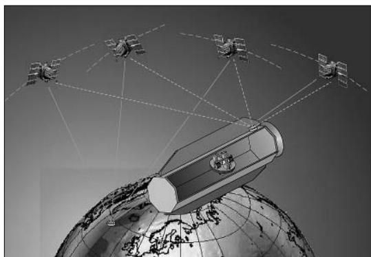
6. ábra A GOCE űrgradiométeres műhold képe, melynek pályáját a GPS-műholdak segítségével határozzák meg nagy pontossággal (Forrás: GOCE Projektbüro, München)
