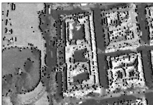
2. ábra Az ImageStation (ponttal jelölve) és az LPS (X-szel jelölve) automatikus kiértékelés során kapott pontok elhelyezkedésének összehasonlítása
