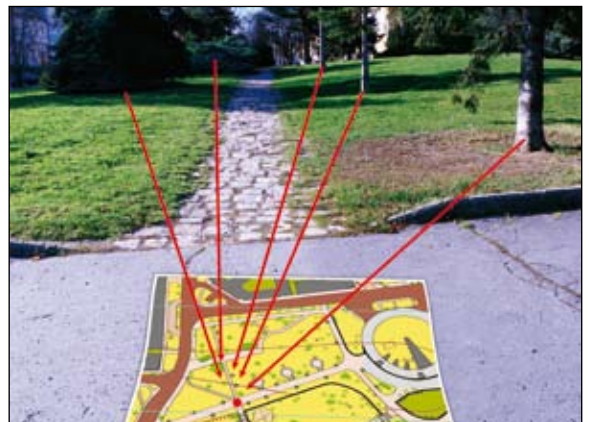
15. ábra. Terep és a térkép azonos pontjainak megfeleltetése
