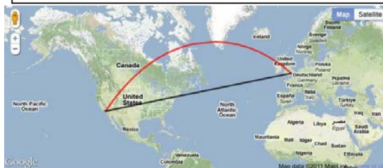
14.13. ábra. A geodesic változó két értéke: ha igaz, a két pontot egy gömbi főkörrel kötjük össze, ennek a térképi vetülete pirossal látható. Ha hamis, a két pont között egyenest rajzol a térképen. A szögtartó Mercator vetület tulajdonságai miatt a gömbi főkör hosszabbnak tűnik. (© 2014 Google)
