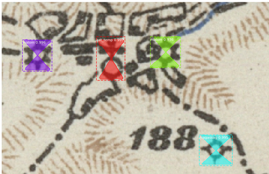
18. ábra Helyes detektálás két malomjel, egy kör alapú templom és egy magassági pont azonosításával.
