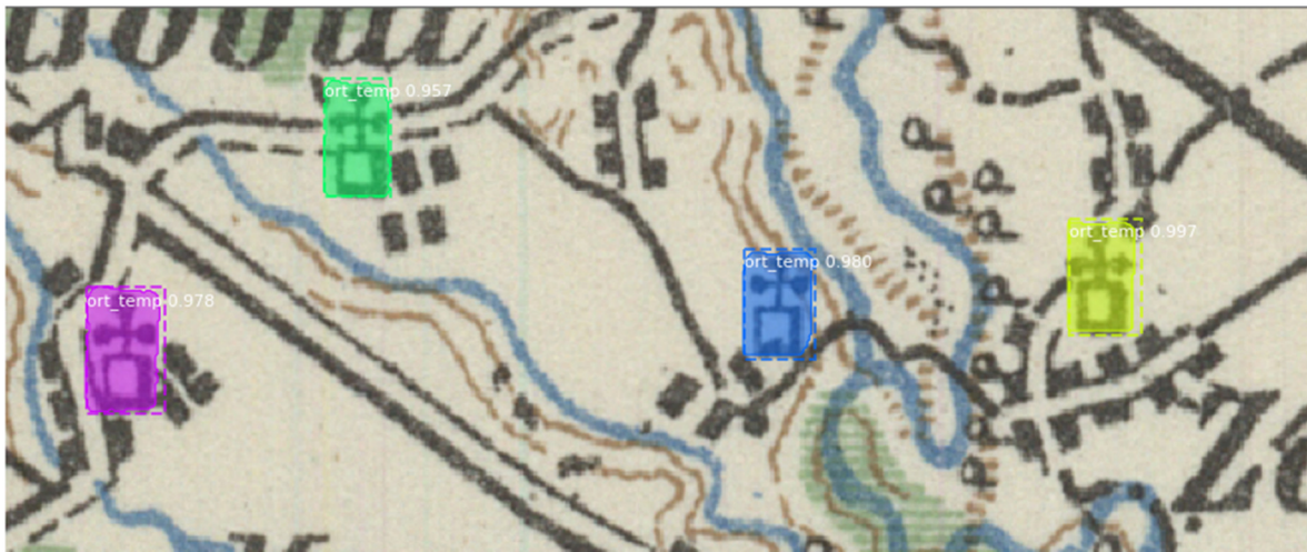
14. ábra A detektálás eredménye a program által megjelenítve. A képen színes maszkokkal négy detektált négyzet alapú templom látható.
