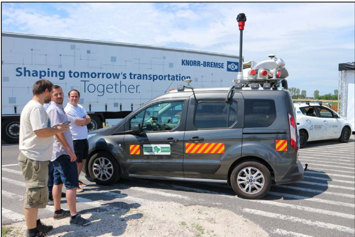
4. ábra: Felmérőautó a felszerelt Riegl VMX-450 típusú lézerszkennerekkel és a LadyBug kamerával Forrás: https://raketa.hu/uploads/2020/06/IMG_7530-1600x1066.jpg
