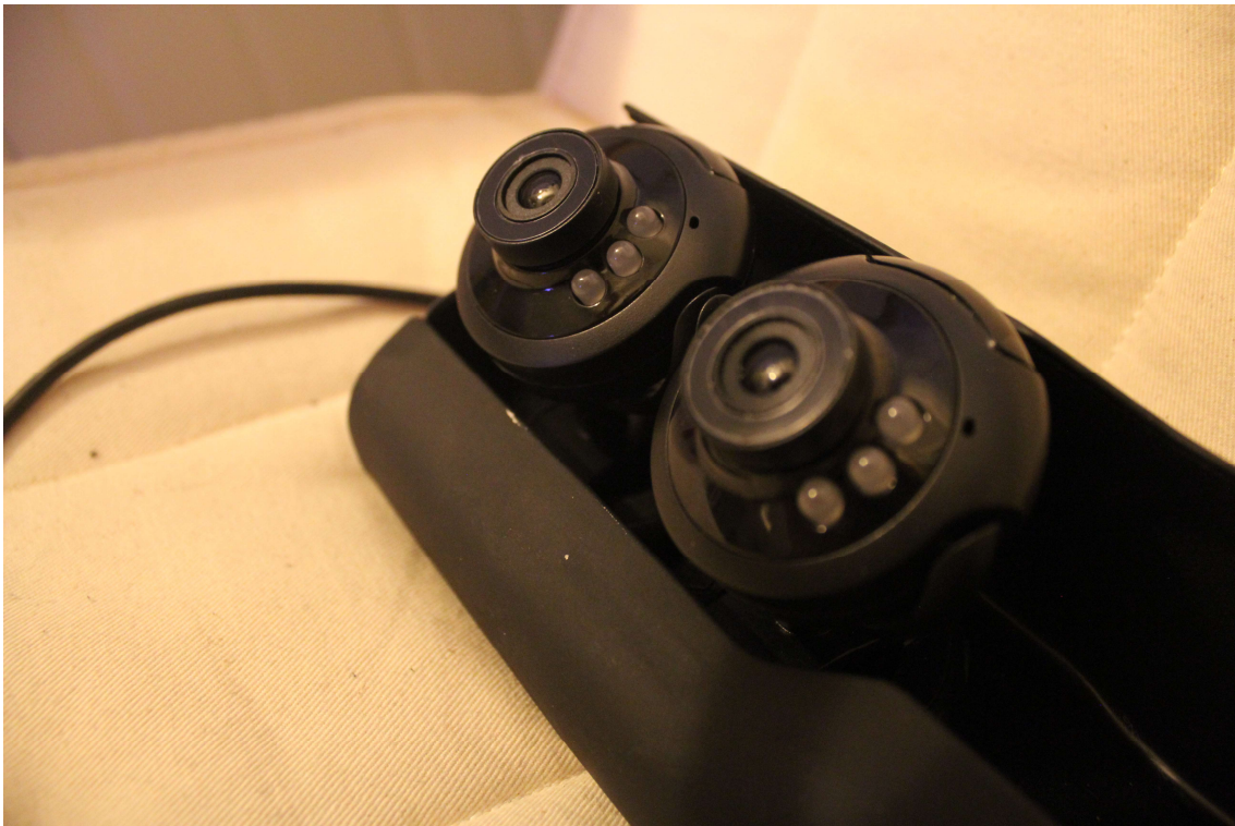
7. kép: A megépített rendszer sztereokamera része
