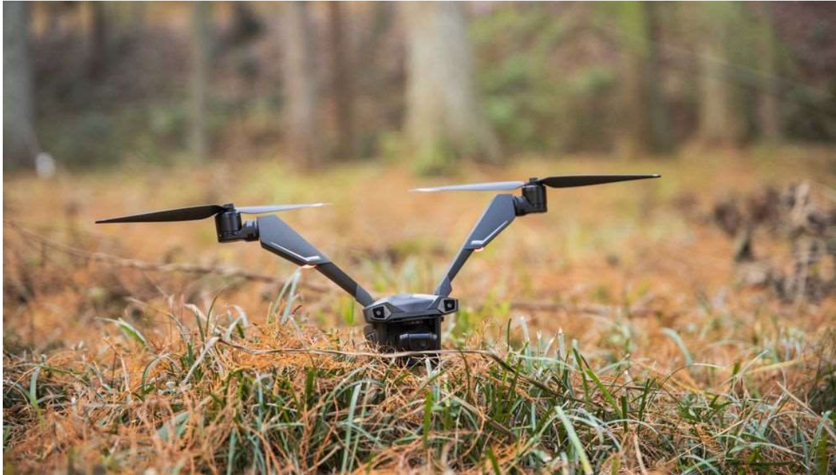
6. kép: Példa egy gyárilag sztereokamerákkal felszerelt drónra (V-Coptr Falcon)
