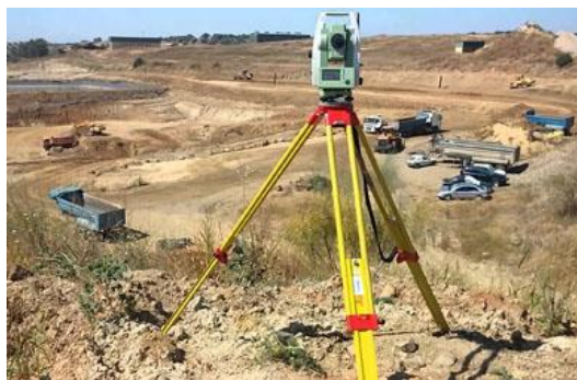
4. ábra: Terepi felméréséhez használt műszer, a teodolit (Forrás: www.foldmeres-dunantul.hu )
