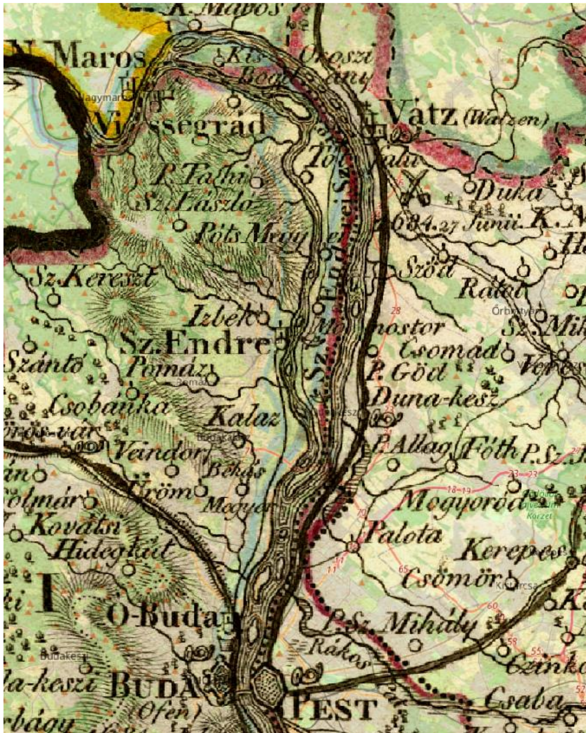
4. ábra: részlet a georeferált Görög–Kerekes-féle Pest-Pilis-Solt vármegye térképről, OpenStreetMap háttérképpel vegyítve. Látható, hogy a kelet–nyugati irányú hibák nagyobbak, mint az észak–déli irányúak, ami a kor mérési technológiájából adódik.
