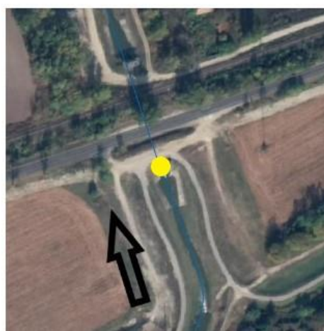
12. ábra: A LiDAR DEM hibái (sárgával) Környe, Tatabánya, Tata, illetve Dunaalmás közelében. A nyilak a folyásirányt mutatják, a háttérben a Google Maps műholdfelvételei láthatók.
