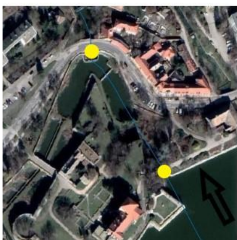
12. ábra: A LiDAR DEM hibái (sárgával) Környe, Tatabánya, Tata, illetve Dunaalmás közelében. A nyilak a folyásirányt mutatják, a háttérben a Google Maps műholdfelvételei láthatók.
