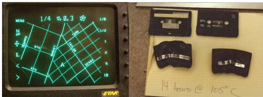
4. ábra: a) Etak Navigator b) Megolvadt kazetták a tesztek során (EDWARDS 2015)
