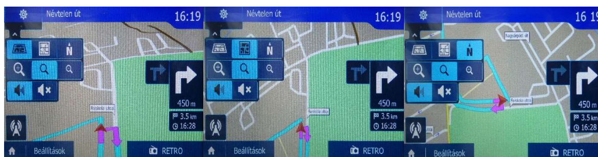
24. ábra: Lehetséges nézetek a beépített GPS-en a) perspektív b) felülnézeti c) északra tájolt
