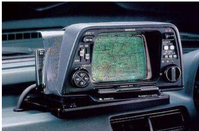
3. ábra: Az Electro Gyro-Cator (Leite 2018)
