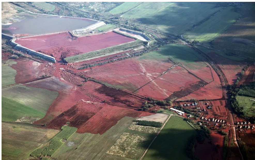
1. ábra A X. számú tározó az átszakadás után (fotó: Somogyi-Tóth Péter, Greenpeace) https://index.hu/nagykep/2012/10/04/ket_eve_tortent_a_vorosizsap-katasztrofa/
