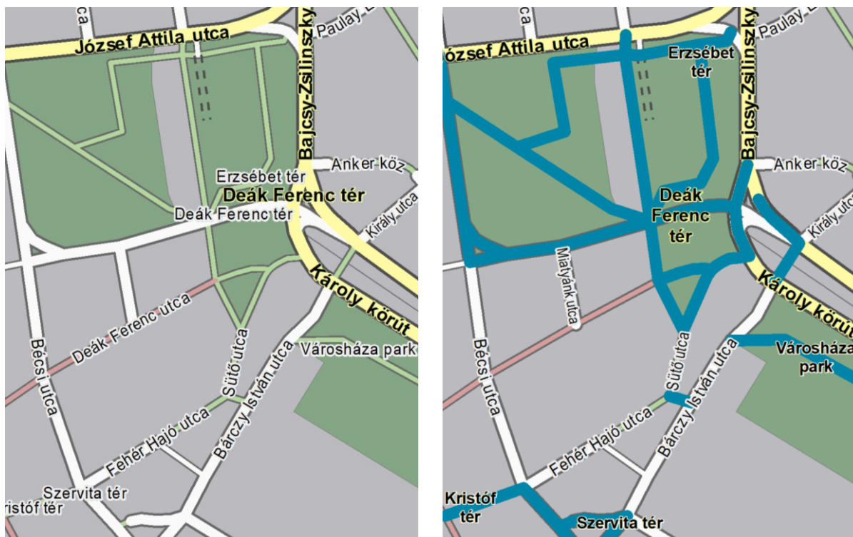
11. ábra: A térnevek felhelyezése az útgráf nyers objektumaira (b) és a generált (j) tér-geometriákra (kék színnel kiemelve) (1 : 5 000)
