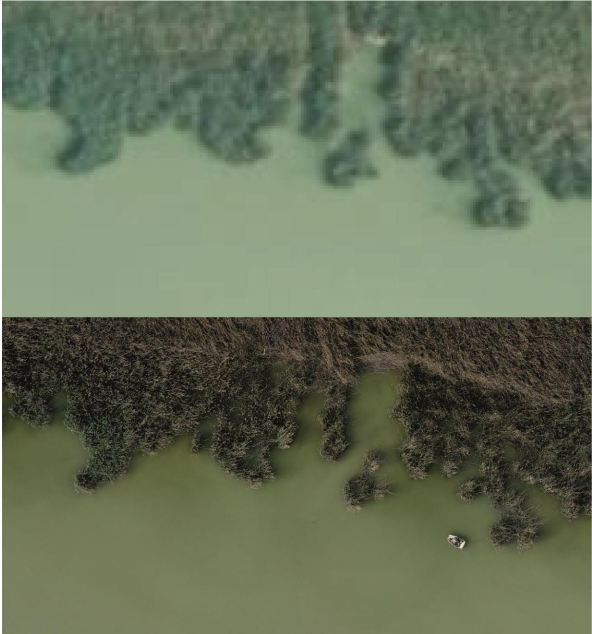
2. ábra: Egy hagyományos ortofotó és egy drón távérzékelte légifelvétel közötti különbség 1:300-as nagyításnál. Forrás: saját szerkesztés
